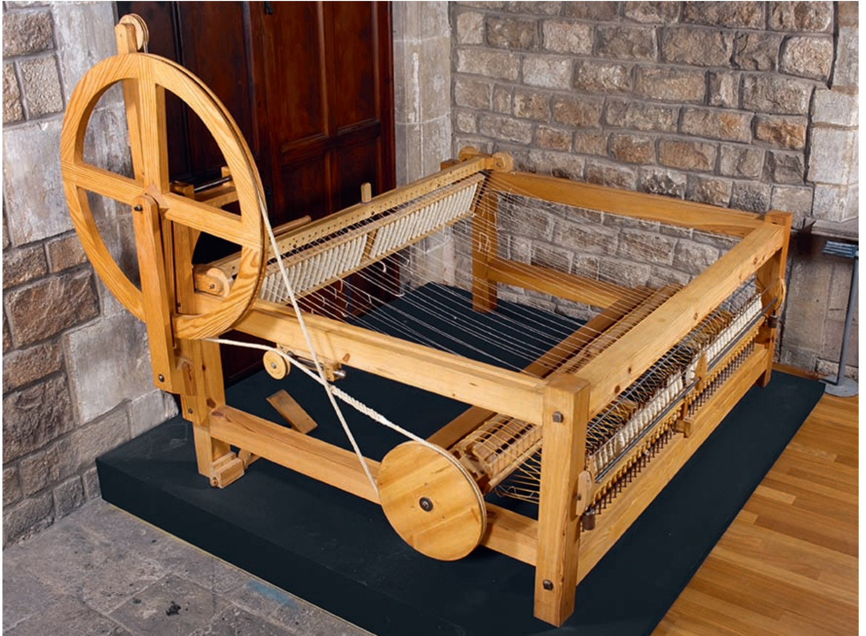
Bergadana. Màquina de filar construïda a Berga per Ramon Farguell a finals del segle XVIII (reproducció a escala 1:1). Museu Nacional de la Ciència i la Tècnica de Catalunya. MNACTEC - 7995. Vista de la peça instal·lada en l'exposició al Saló del Tinell
